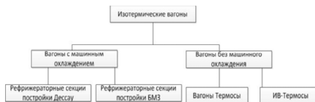
Рис. 1/ Схема современного изотермического подвижного состава
